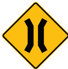
Ponte Estreita (A-22)
