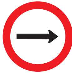
Sentido de Circulação da Via / Pista (R-24a)
