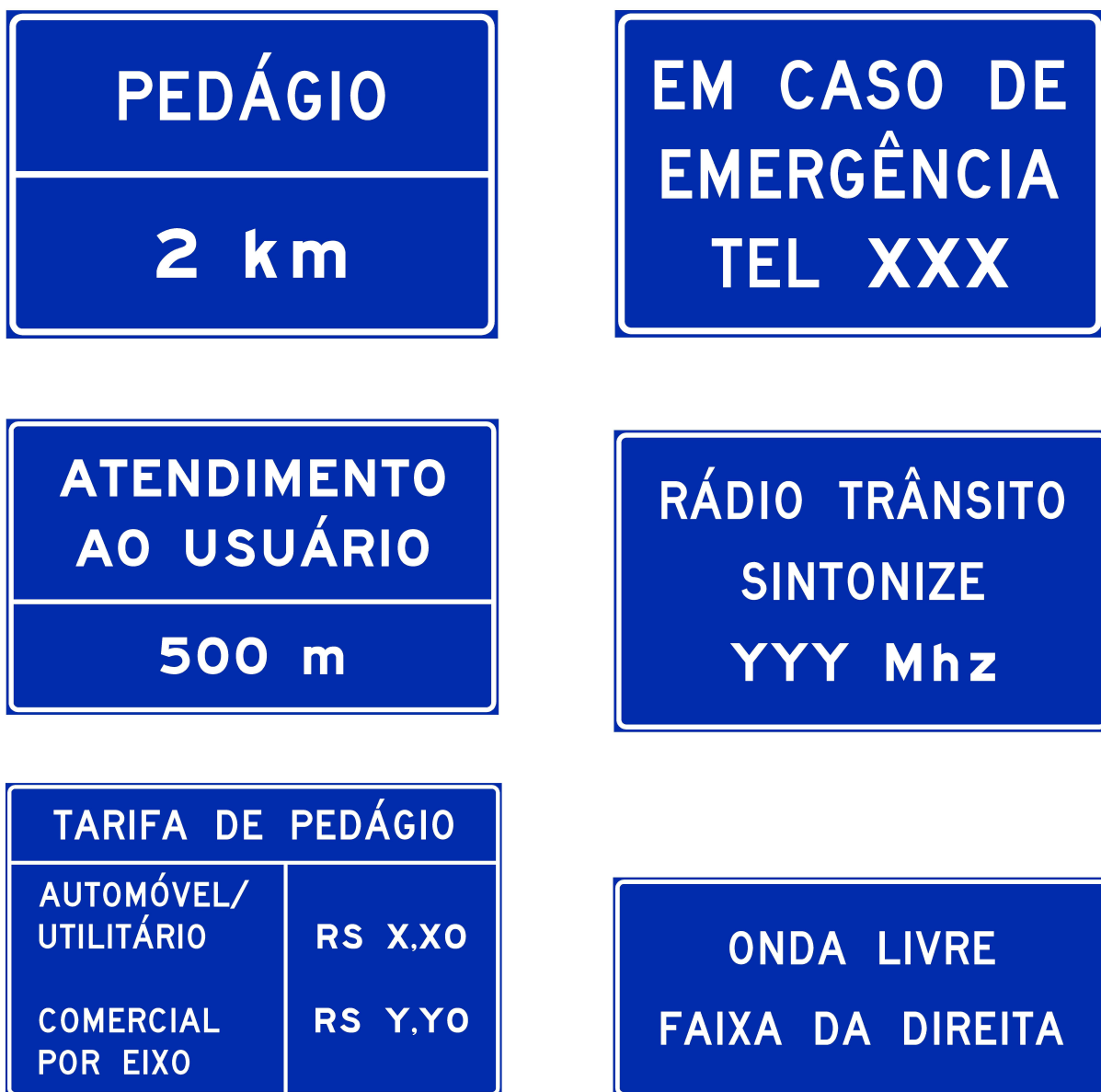
Figura 206 – Sinais indicativos de mensagens operacionais
