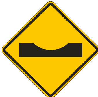
Figura 111 – Sinal A-19 – Depressão
