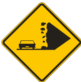
Figura123 – Sinal A-27 – Área com desmoronamento
