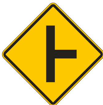
Figura 96 – Sinal A-7b - Via lateral à direita
