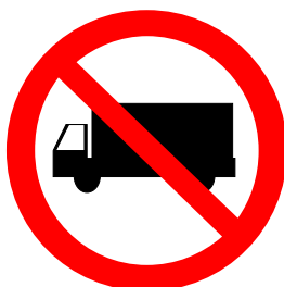
Figura 67 – Sinal R-9 – Proibido o trânsito de veículos de carga
