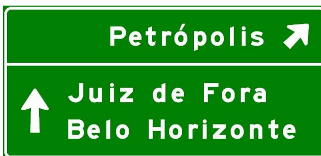
Figura 177 – Alinhamento pelo lado da seta
