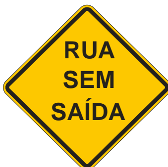
Figura152 – Sinal A-45 – Rua sem saída
