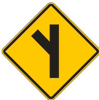
Figura 100 – Sinal A-10a – Entroncamento oblíquo à esquerda
