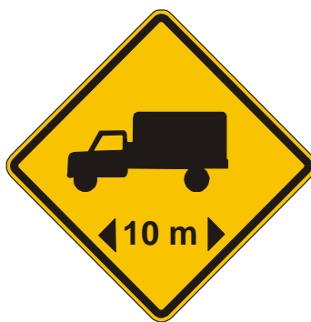
Figura148 – Sinal A-48 – Comprimento limitado
