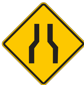
Figura 114 – Sinal A-21a – Estreitamento de pista ao centro
