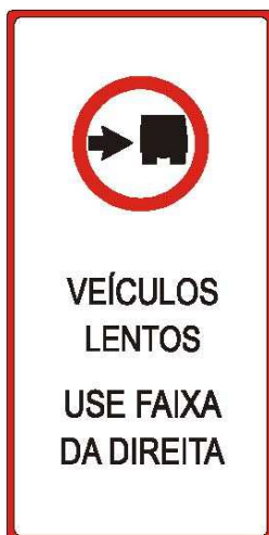
Figura 78 – Sinal de regulamentação composto
