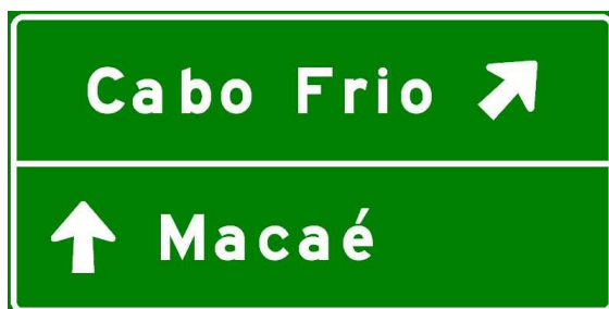
Figura 185 - Acesso à direita
